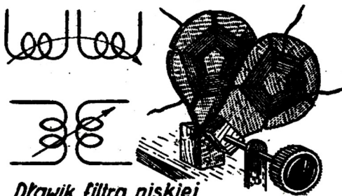
Dwie cewki ze zmiennym sprzężeniem
